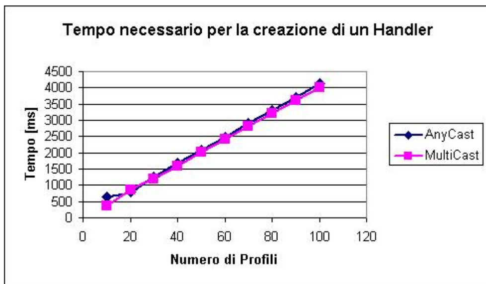
Figura 5.15: Tempo necessario alla creazione di un Handler con profili di 4 Attributi
