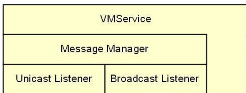
Figura 4.6: Architettura logica del View Manager Service.
