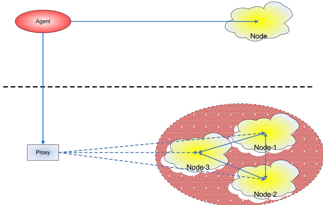
La soluzione proposta sfrutta la programmazione orientata agli aspetti per catturare ogni chiamata a metodi che accedono ai centri di coordinazione. Tali chiamate vengono sostituite con un blocco di codice che provvede a ciclare sulla lista di nodi e su di essi inoltra la chiamata fermandosi al primo nodo che trova disponibile.
