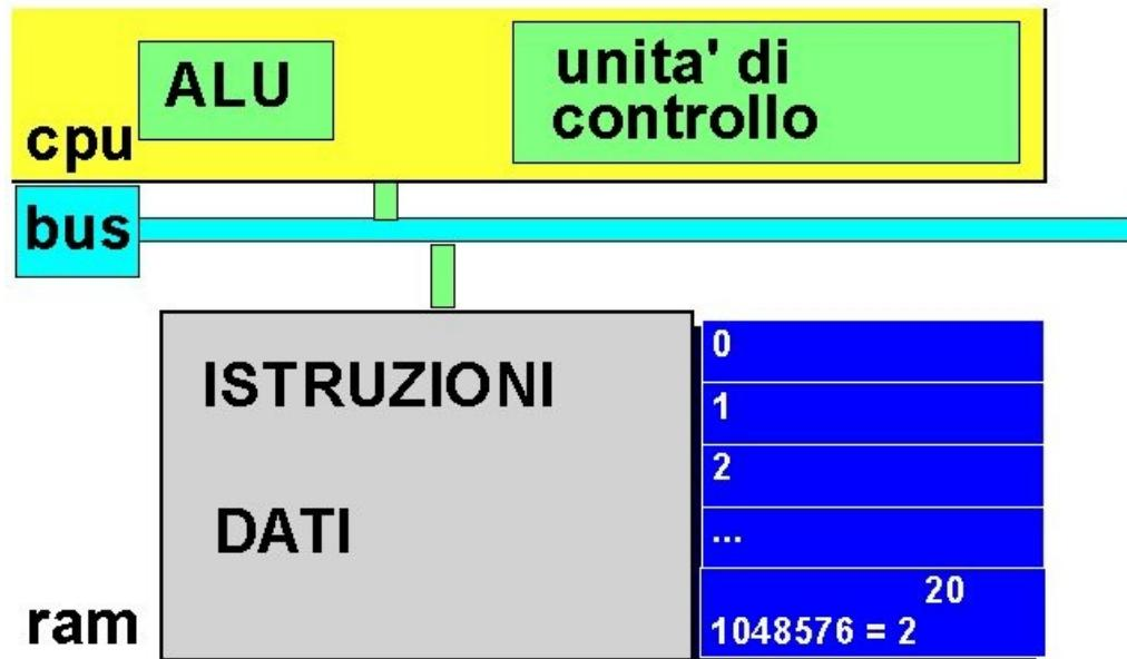
L'unità di controllo fa funzionare l'elaboratore.
