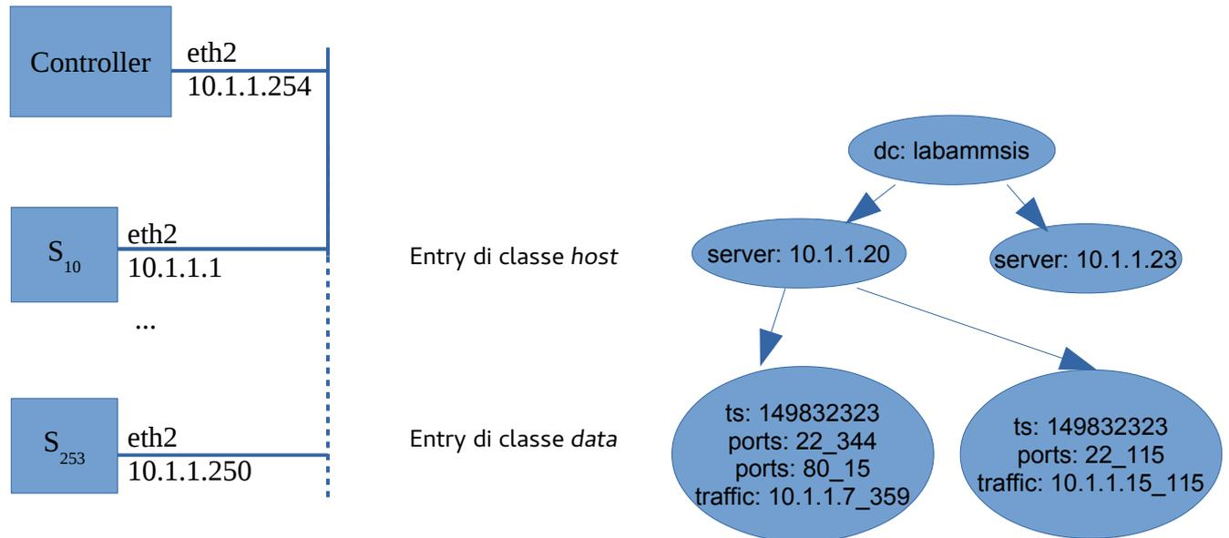
Il sistema di monitoraggio rappresentato in figura prevede un insieme di 250 Server e un Controller. Il Controller verifica lo stato di attività dei server, garantendo che quando sono accesi essi si trovino in una di due situazioni: o sono in grado di inviargli informazioni sul traffico che ricevono, oppure devono essere isolati dal resto dei server per evitare intrusioni non rilevabili.
