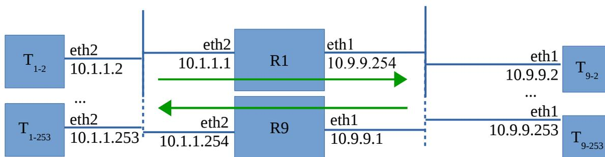
Un sistema di instradamento e controllo del traffico ad alta disponibilità è costituito da una coppia di macchine “controller” (R1 e R9) che in condizioni normali inoltrano unidirezionalmente il traffico da una rete “target” all’altra, bloccando i pacchetti che contengono traffico vietato (descritto da una lista di pattern specificati da un file di configurazione).
