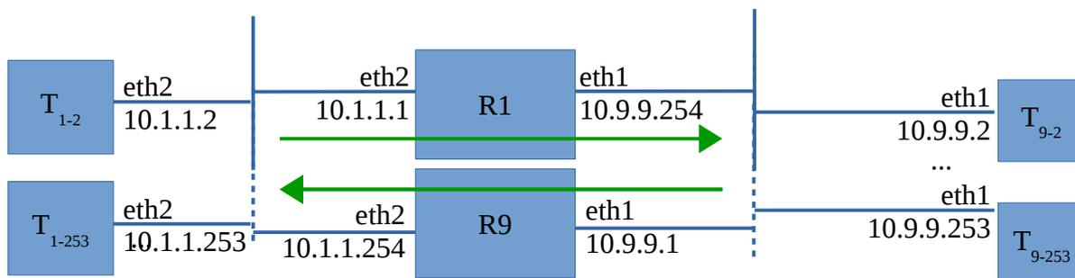
Un sistema di instradamento e controllo del traffico ad alta disponibilità è costituito da una coppia di macchine “controller” (R1 e R9) che in condizioni normali inoltrano unidirezionalmente il traffico da una rete “target” all’altra, bloccando il traffico anomalo (cioè quello che si discosta dai pattern leciti specificati da un file di configurazione).
