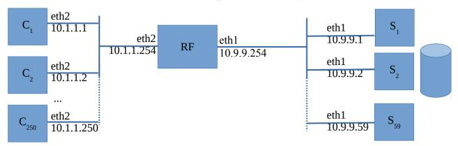
Il sistema di "scripting as a service" rappresentato in figura prevede un insieme di 250 Client, 59 Server, e un Router-Firewall (RF) tra le rispettive reti. Il RF media le richieste di esecuzione remota di codice inviate dai client ai server.
